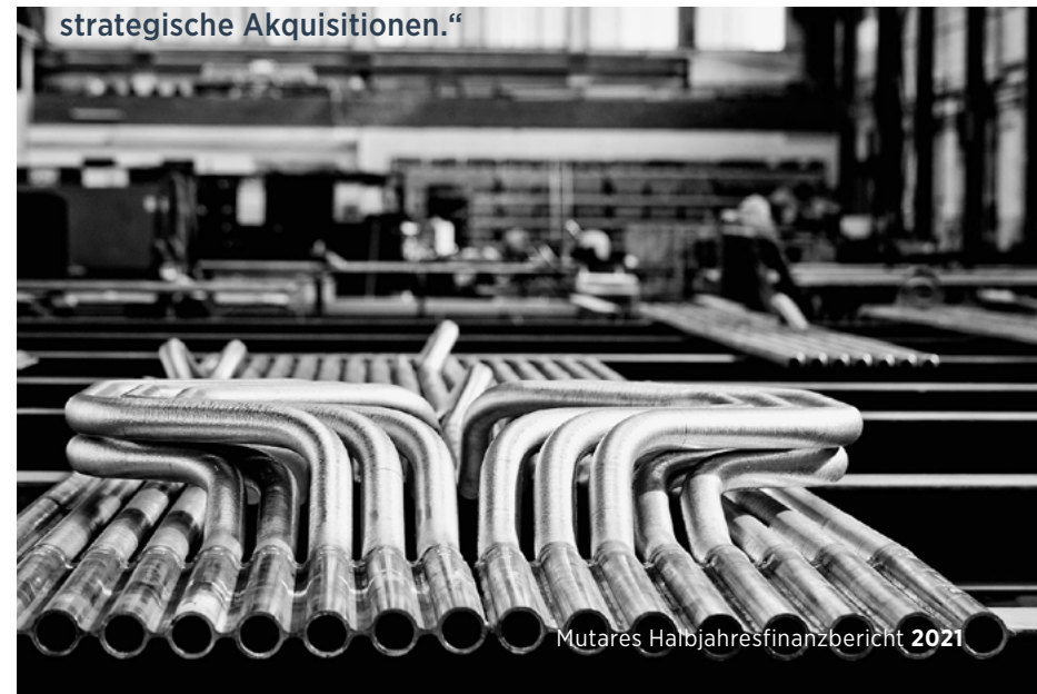
Rohrausbiegungen als Teil eines Austausch von Kesseldruckteilen
